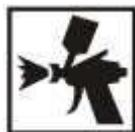
Наносить с помощью пистолета-распылителя, оборудованного соплом Ø1,2-Ø1,4 мм при давлении воздуха от 3,0 до 4,0 бар.
